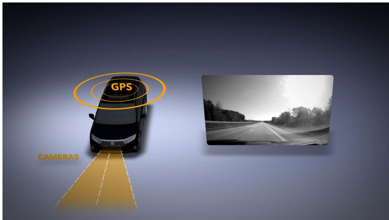
El Instituto de Investigación de Honda está realizando un programa piloto en Ohio para evaluar un sistema que utiliza coordenadas GPS y sensores, como cámaras, para recopilar información sobre el estado de las carreteras en tiempo real, que puede compartirse con los operadores. Honda planea comenzar a proporcionar datos sobre el estado de las carreteras a principios de
